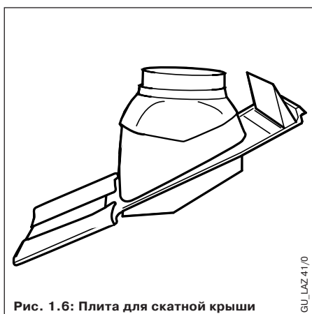
Рис. 1.6: Плита для скатной крыши
